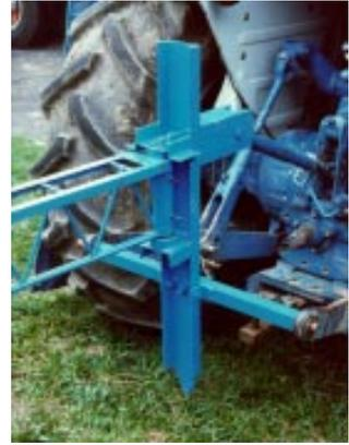
**Figura 6.** Estructura de soporte del brazo vibrador.
