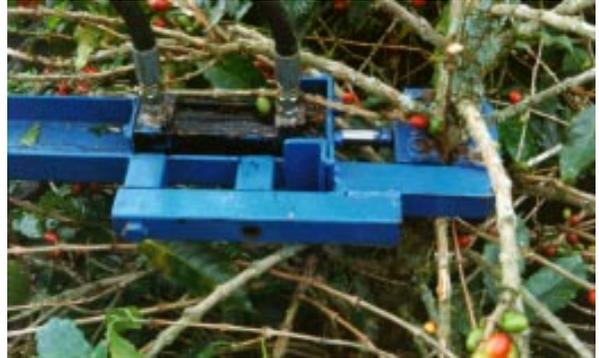
**Figura 5.** Mecanismo de sujeción al tallo del vibrador circular diseñado en Cenicafé.
