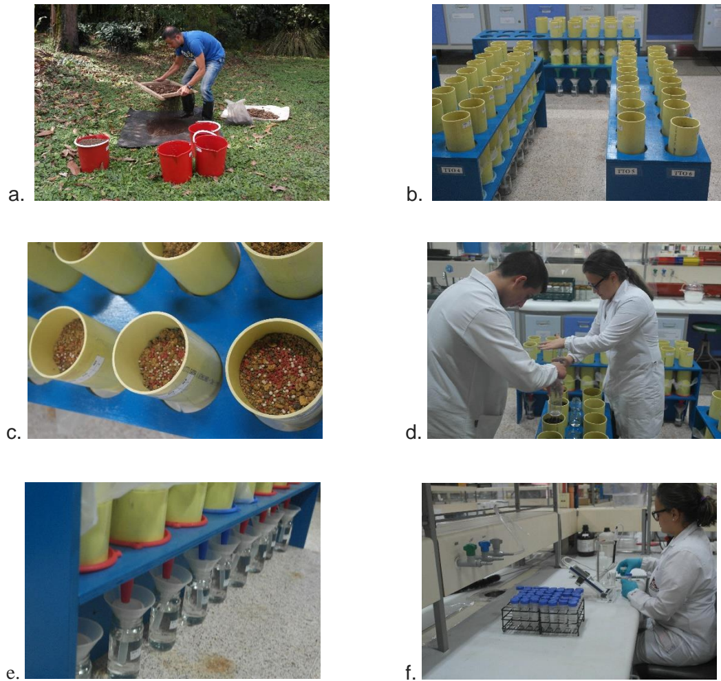
Figura 3. Procedimiento para la evaluación de lixiviación de bases. a. Preparación de la muestra de suelo, b. Montaje de suelo en los cilindros de PVC, c. aplicación de tratamientos, d. aplicación de agua, e. recolección del lixiviado, f. análisis del lixiviado.
