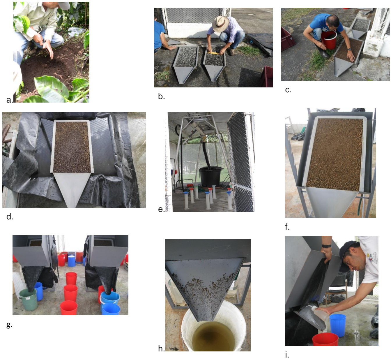
Figura 4. Evaluación de la pérdida de suelo por lluvia simulada. a. Toma de la muestra en campo, b y c. preparación de las bandejas para simulación, d. saturación de la muestra de suelo, e. calibración de la intensidad de la lluvia en el simulador oscilatorio, f. ubicación de la bandeja con una inclinación de pendiente máxima, g. recolección de agua de escorrentía y sedimentos, h, i. recolección de sedimentos en la lengüeta.
