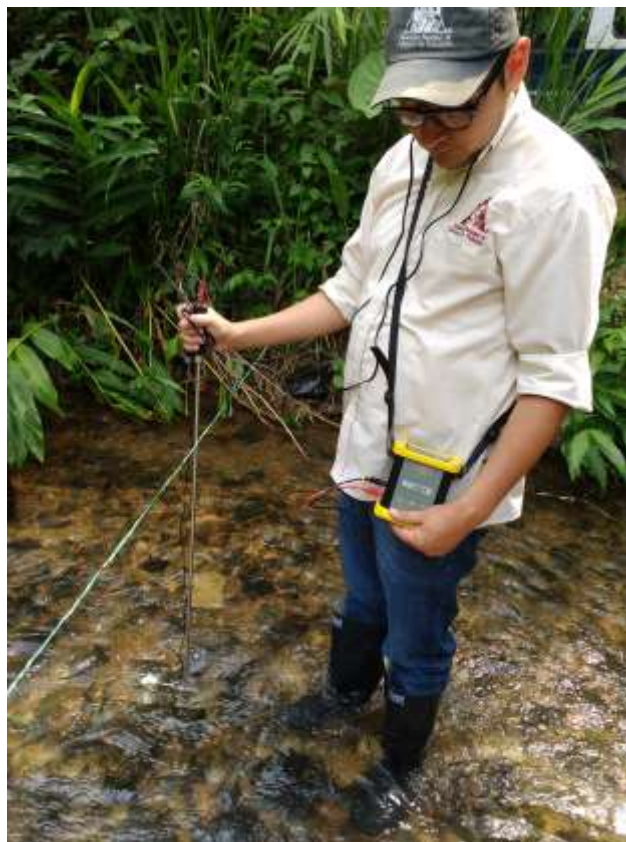
Figura 6. Medición de caudal mediante el uso de un molinete
