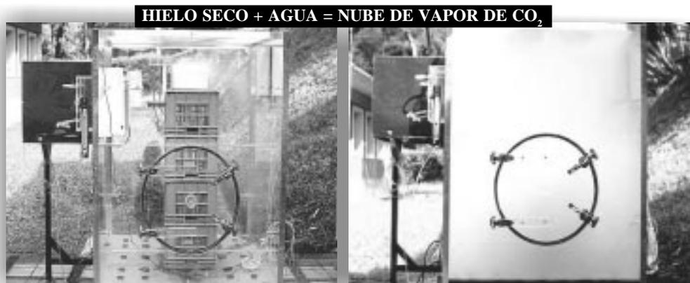
Figura 2. Prueba para la detección de fugas de aire en las cámaras de intercambio gaseoso.
