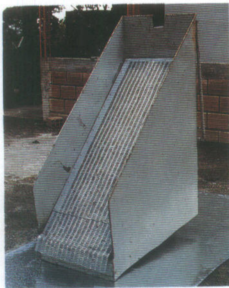
Figura 4. Separador pulpa-agua construído en lámina.
