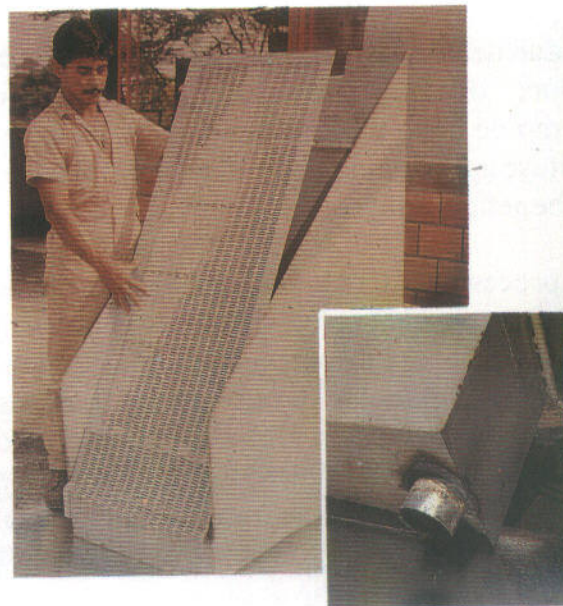
Figura 5. "Fondo" del separador agua-pulpa construído en lámina. (abajo) Detalle del orificio de salida del agua separada de la pulpa.
