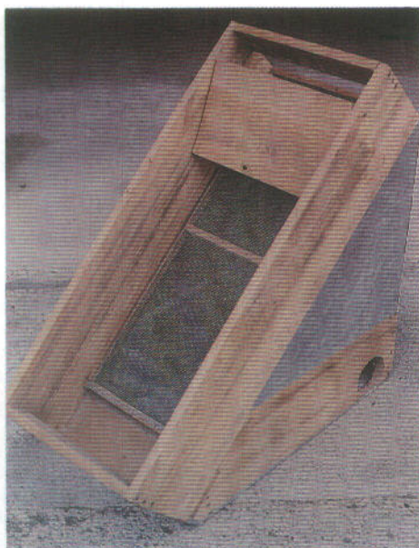
Separador construido en madera y anejo.
