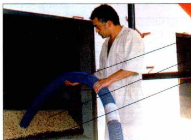
Figura 99. Silo secador tipo CENICAFÉ para café pergamino, en capas estáticas de secado y presecado, con inversión de la dirección del flujo del aire. Descarga neumática.
