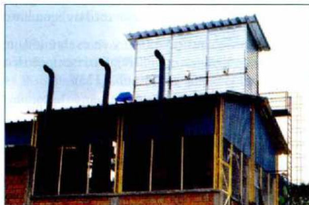
Figura 102. Secadores intermitentes de flujos concurrentes, CENICAFÉ - IFC.
