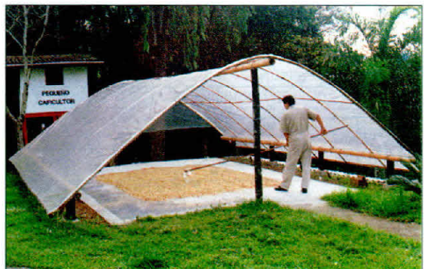
Figura 91. Secador Solar con estructura de marquesina de plástico en forma parabólica.
