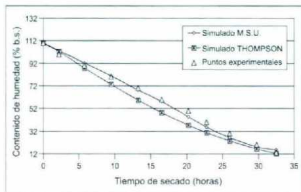
Figura 115. Comparación de datos experimentales con curvas de simulación de secado de café pergamino, en secador intermitente de flujos concurrentes, IFC, mediante dos modelos matemáticos (M.S.U. y de Thompson).
