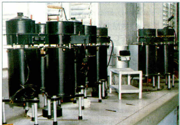
Figura 87. Banco de ocho determinadores de humedad CENICAFÉ MH-2 para control del café recibido y secado en la CBEA. (Sección 3.19.).
