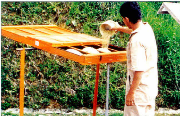
Figura 89. Secador solar rotatorio para café.
