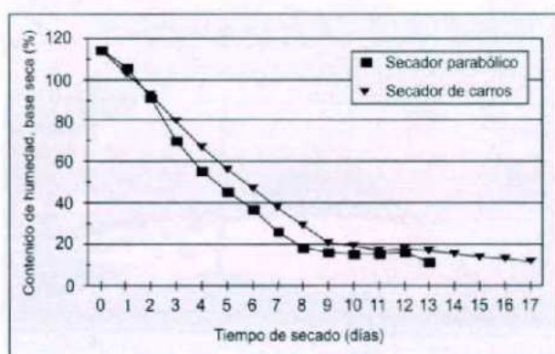
Figura 92. Comparación del secador de capas de café dispuestas en los carros tradicionales y en el secador solar parabólico
