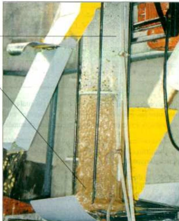
**Figura 32.** Alto volumen de mucilago desprendido en los primeros instantes del proceso de desmucilaginado mecánico (sección inferior del equipo). Se diferencian las etapas de desmucilaginado (parte inferior) y de lavado con flujos de agua y de grano en contracorriente (parte superior).
