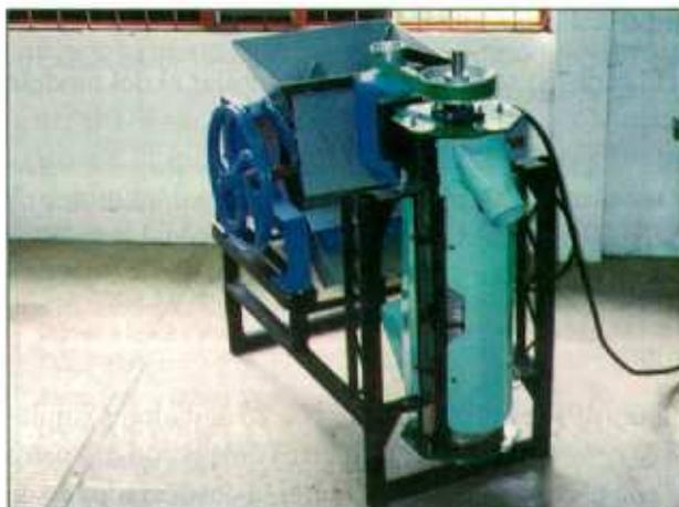
**Figura 49.** Modelo DESLIM 3000 con despulpadora de doble disco y capacidad de 2.500kg café cereza/hora.
