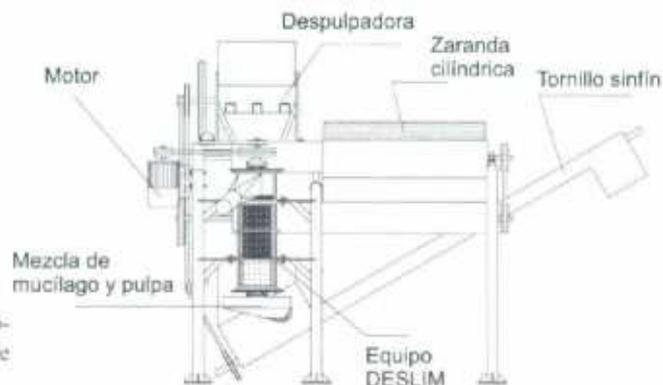
**Figura 66.** Vista lateral del módulo BECOLSUB provisto de zaranda cilíndrica.
