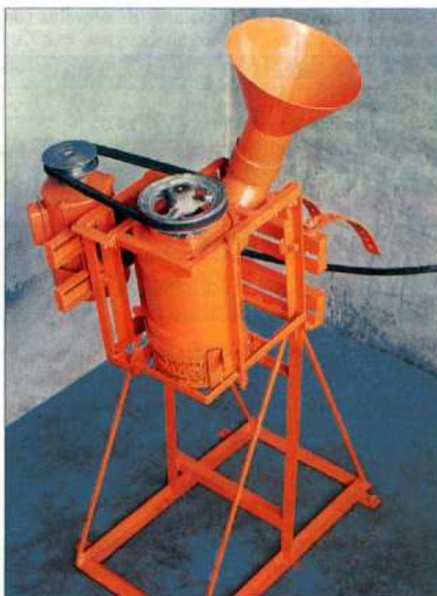
**Figura 36.** Desmucilagador por agitación con rotor tipo CENICAFÉ-B-I.
