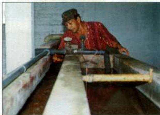
**Figura 28.** Canal semisumergido utilizado para el lavado y clasificación tradicional del café pergamino.
