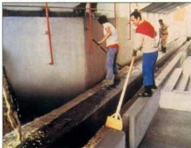
**Figura 25.** Lavado del café con mucílago fermentado en canales de correteo, mediante agitación manual.
