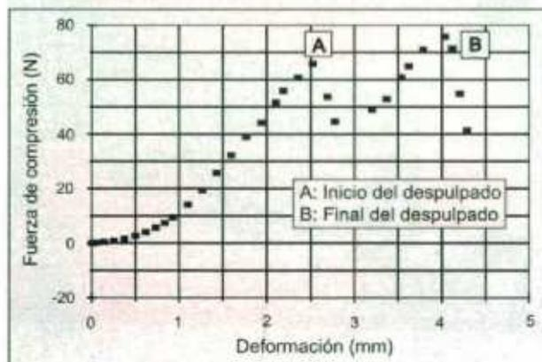
**Figura 16.** Comportamiento de una cereza madura de café sometida a compresión entre placas paralelas.
