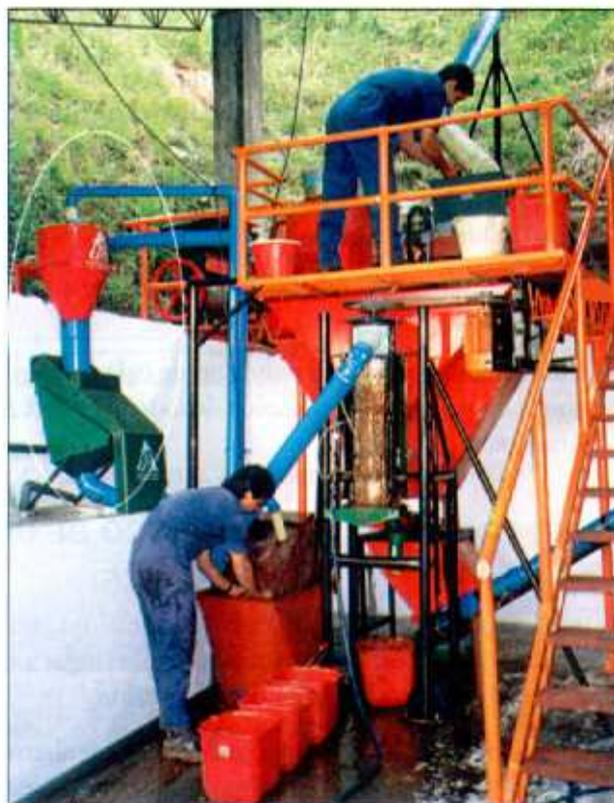
**Figura 57.** Operación del hidrociclón acoplado a un módulo BE-COLSUB, en Cenicafé.
