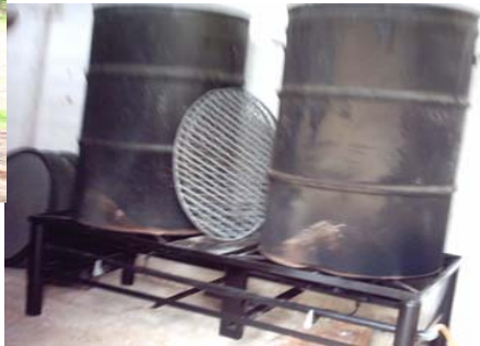
Canecas para la esterilización de los sustratos al vapor.
