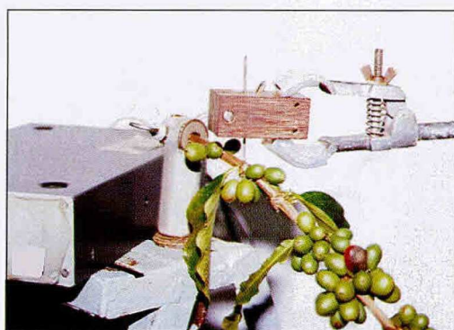
Figura 3. Montaje del LVDT para determinar la frecuencia y el amortiguamiento de una rama de café.
