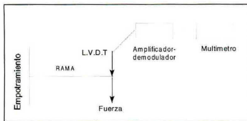
Figura 1. Montaje para determinar el módulo de Young a flexión de la rama de café.
