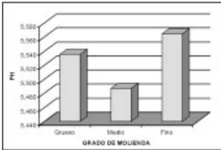
Figura 17. Valores medios del pH del extracto de café para cada grado de molienda.
