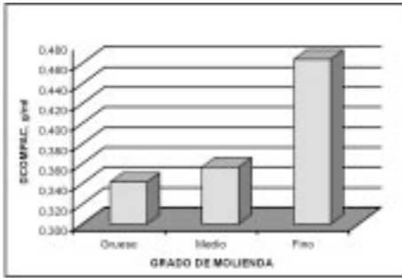
Figura 15. Valores medios de densidad por compactación para cada grado de molienda.
