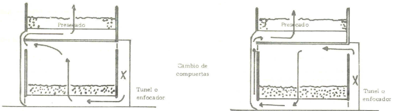
FIGURA 56. Silo de un compartimiento, con presecado.
