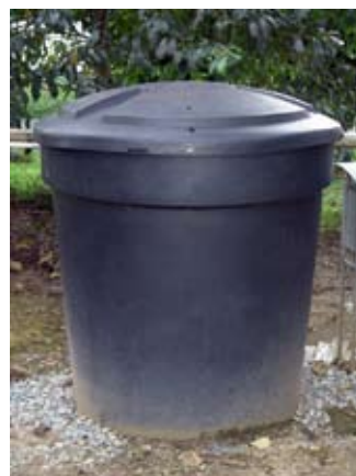
Figura 13. Tanque de polietileno utilizado como reactor metanogénico.
