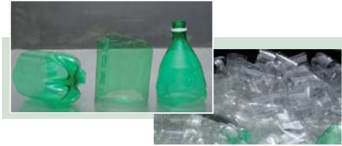
Figura 14 . Botellas plásticas no retornables (BPNR) para soporte de microorganismos anaerobios.
