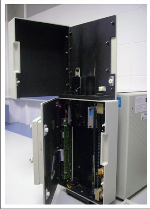
**Figura 1.** Equipo de mesa. Espectrofotómetro monocromador (Foss 6500).
