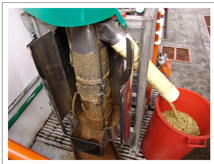
Figura 2. Estado de la carcasa del equipo durante el lavado del café.
