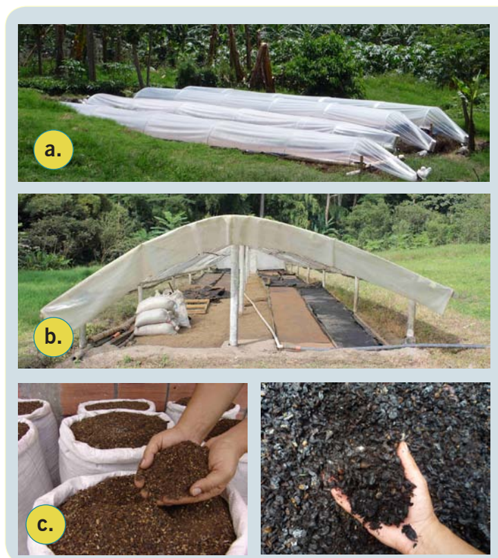
Figura 6. a y b. Secadores solares tipo túnel diseñados para el secado de mieles del lavado del café obtenidas con la tecnología ECOMILL®; c. Mucílago seco y pulpa descompuesta.
