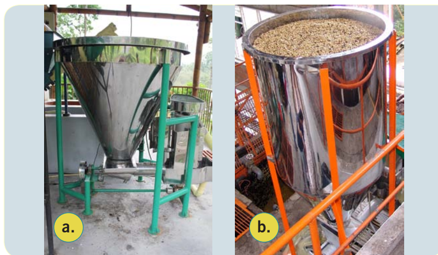
Figura 1. Tanque utilizado para la fermentación del mucílago del café en la tecnología: a. ECOMILL ® 500; b. ECOMILL ® 1.500 y 3.000.
