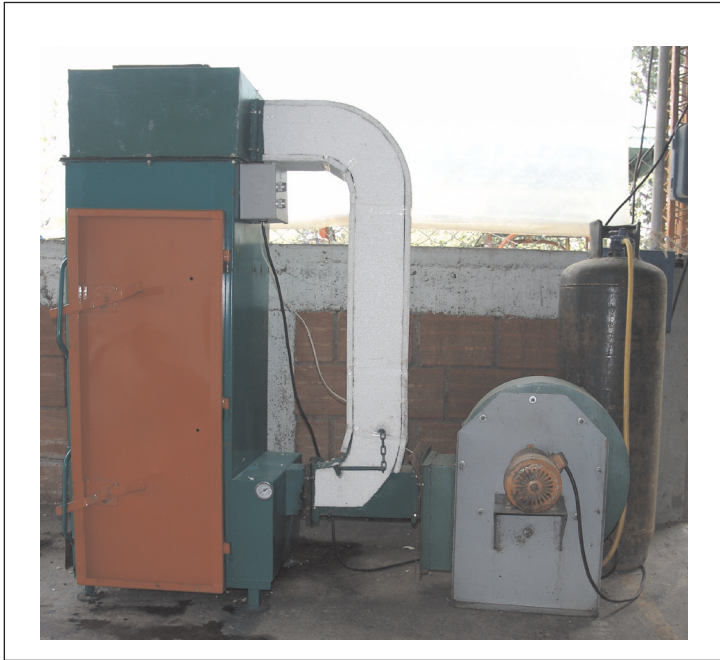
Figura 3. Secador modificado a tipo Cenicafé utilizado en los ensayos
