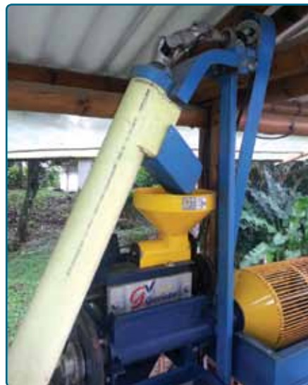
Figura 6. Transmisión de potencia desde el eje de la despulpadora.
