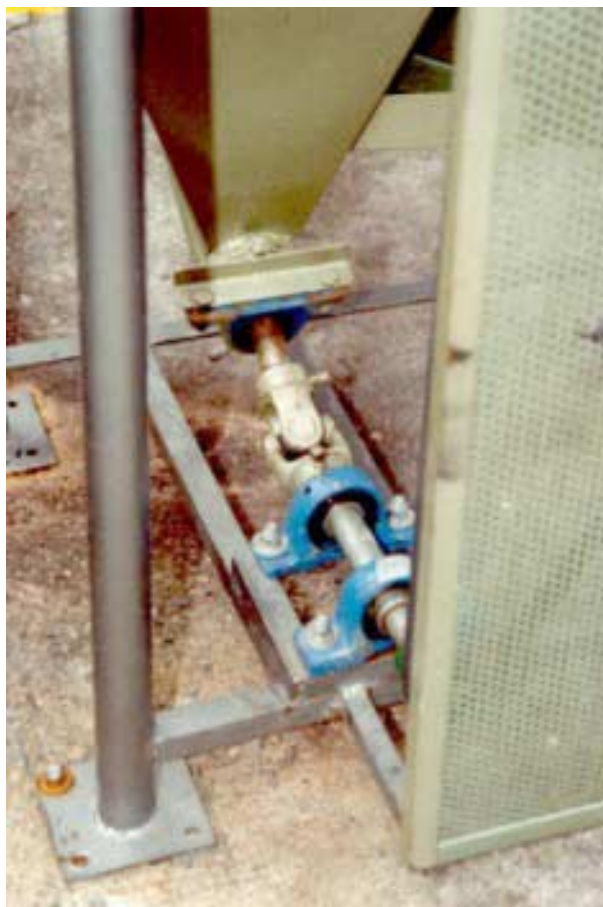
Figura 3. Accionamiento del tornillo sinfín en el módulo BECOLSUB 300.
