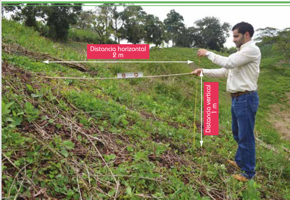
Figura 1. Medición de la pendiente en el terreno.
