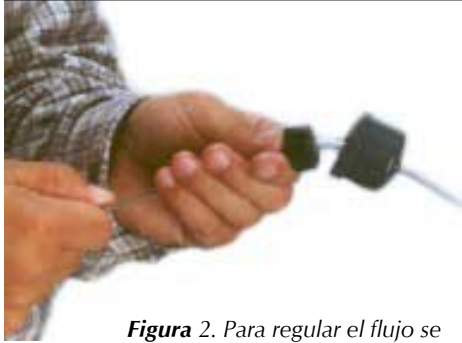
Figura 2. Para regular el flujo se inserta una manguera plástica desde el tapón del Selector hasta la T.
