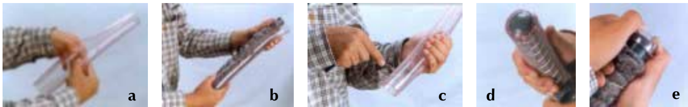
Figura 4. (a) Se utiliza una manguera plástica de 1 pulgada y media, cortada y perforada, la cual va a estar en contacto con las arvenses al momento de operar el equipo. (b) Se instala la manguera de plástico en el equipo a presión, (c) La manguera se perfora para que unte el follaje de las arvenses agresivas, (d) Amarre de la manguera perforada. (e) Los tapones se insertan en la T del selector para evitar el goteo de la mezcla herbicida.
