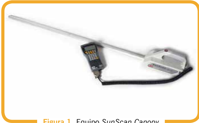
Figura 1. Equipo SunScan Canopy Analysis System.
