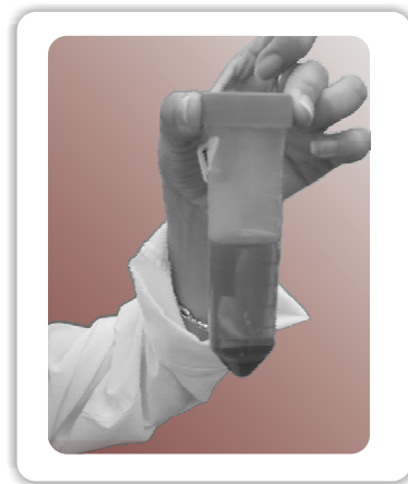
Figura 3. La reacción ácida permite separar la fracción húmica (precipitado) de la fracción fúlvica (sobrenadante amarillo).
