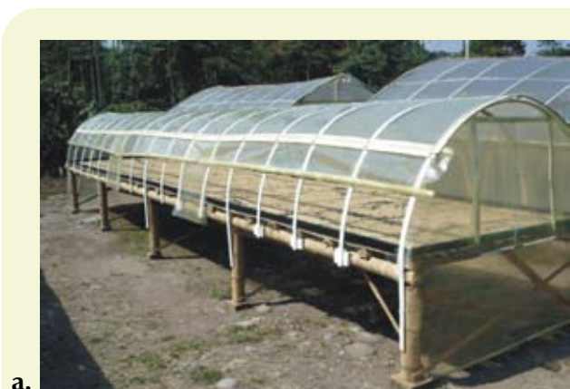
Figura 9. Operación del secador solar de túnel: a) Inicio de secado; b) Etapas avanzadas de secado.
