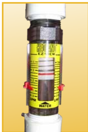
Figura 8. Rotámetro instalado en una tubería.
