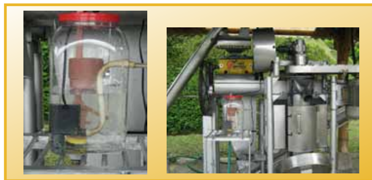
Figura 5. Arreglo con flotador y motobomba sumergible para suministrar constantemente agua a desmucilaginadores Deslim.
