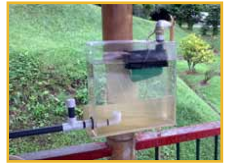
Figura 7. Sistema de placa de orificio calibrada, instalada en un módulo Becolsub 300.
