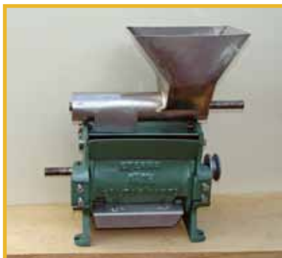
Figura 3. Despulpadora de café de cilindro horizontal con dosificador de tornillo sinfín.
