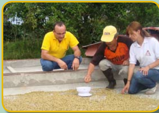
Figura 3. Determinación del peso del café contenido en la canastilla, en la validación del método Gravimet en Investigación Participativa - IPA.
