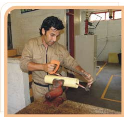
Figura 2. Corte longitudinal del tubo de PVC.
