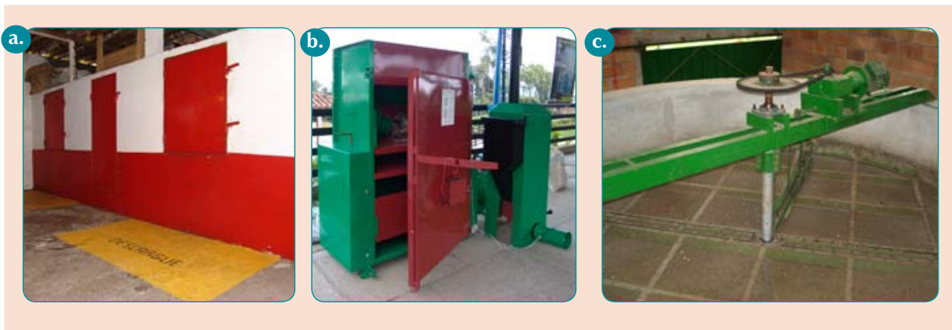
Figura 2. Tecnologías utilizadas para el secado de café en Colombia. a. secador con compuertas para invertir la dirección del flujo del aire; b. secador de dos pisos; c. secador con agitador mecánico de los granos.
