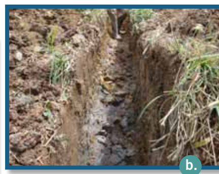
Figura 1. Sitio anegado por aguas superficiales (a) y subsuperficiales (b). Área potencial de deslizamiento. Presencia de horizonte con moteados de color gris azulado, como consecuencia de la oxidación baja del hierro, por problemas de mal drenaje interno del perfil del terreno (b).
