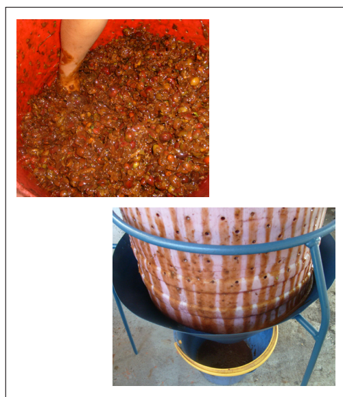
Figura 3. Pulpa y mucílago mezclados y dispuestos libremente para recoger los lixiviados generados.
