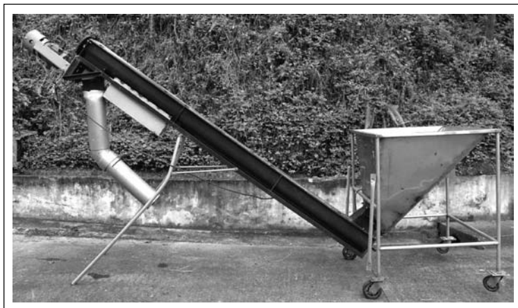
Figura 1. Vista general del Separador Hidráulico de Tornillo Sinfin (SHTS).
