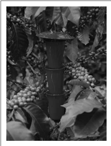
Figura 2. Dispositivo para la captura de adultos de broca, Brocatrap®.
