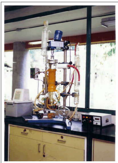
Figura 1. Evaporador de película descendente al vacío.
