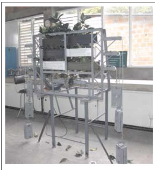
**Figura 1.** Dispositivo empleado para la simulación del rozamiento con las ramas de café.
