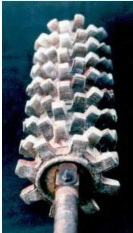
**Figura 3.** Rotor tipo COLMECANO.
