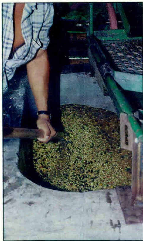
Proceso de agitación para el lavado en el tanque tina.
