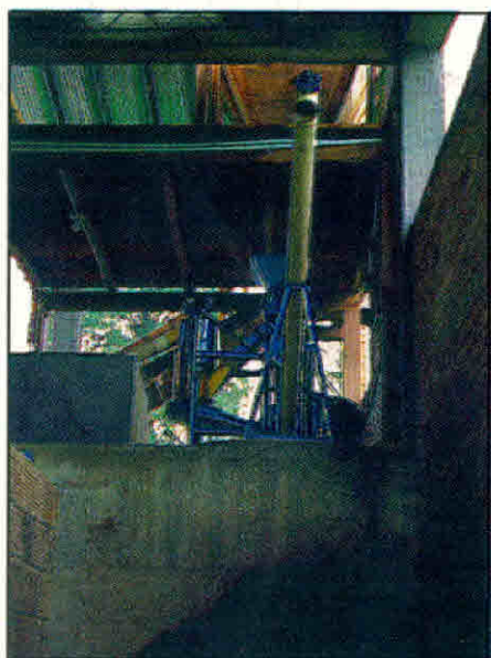
Tornillo sinfin, una forma mecánica de transporte de pulpa
