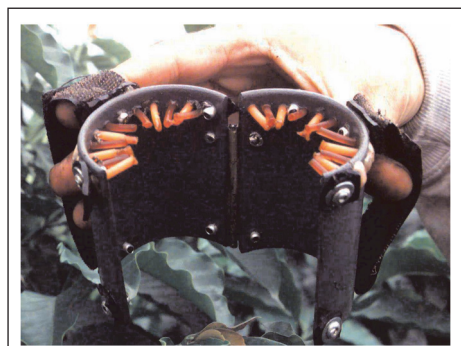
Figura 11. Herramienta para asistir la cosecha manual de café, RASELCA-I
