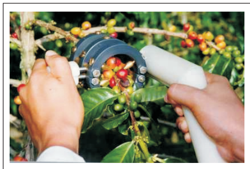
Figura 3. Herramienta para la cosecha de café, ORSEL, desarrollada en Cenicafé. Londoño et al. (5).
