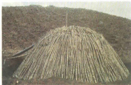
FIGURA 4.- Fácil sistema para fabricar carbón con los troncos cortados.
