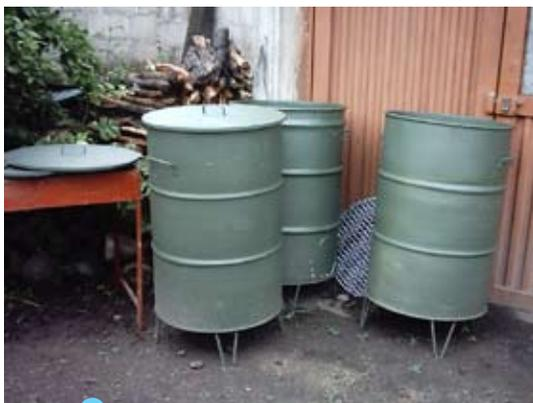
**Figura 24.** Canecas metálicas para la esterilización de los sustratos
