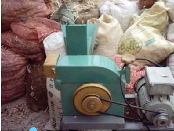
**Figura 9.** Desintegrador - molino para adecuación del tamaño de partícula.
