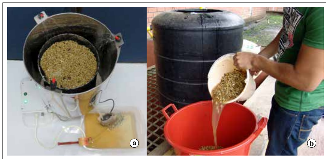
Figura 1. a. Dispositivo utilizado para la aplicación de agua ozonizada al café; b. Recolección de muestra (testigo) después de 96 h de almacenamiento bajo agua
