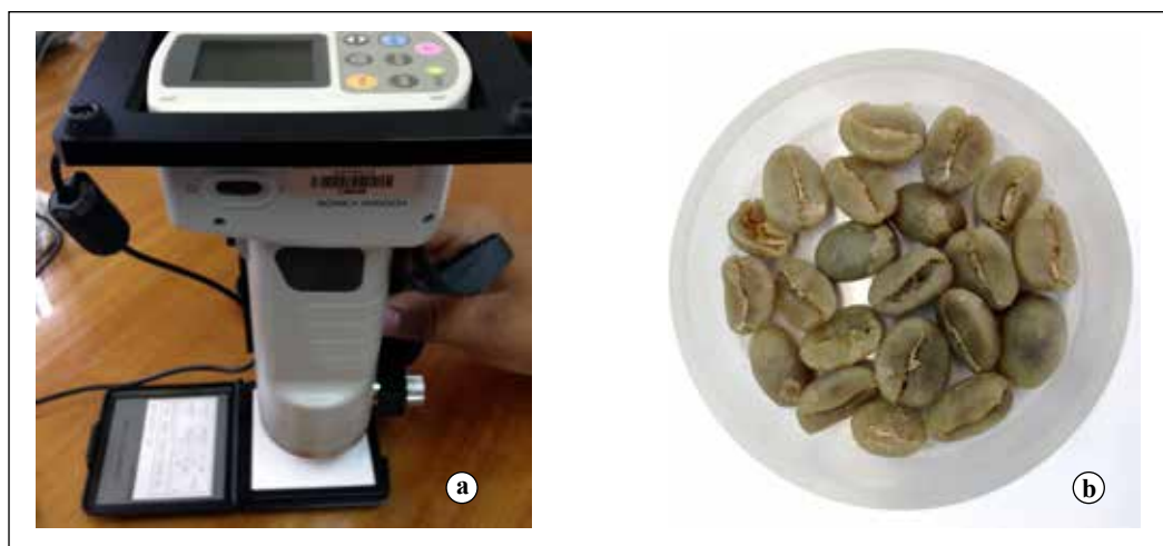
Figura 2. a. Calibración del colorímetro Konica Minolta CR-400; b. Muestra de almendras para análisis de color.
