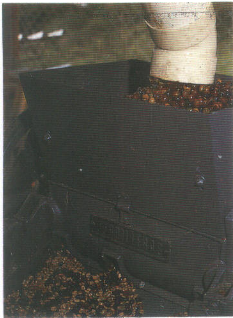
Figura 2. Despulpado sin agua, se observa salida de la cereza en seco a la tolva y el café ya despulpado.
