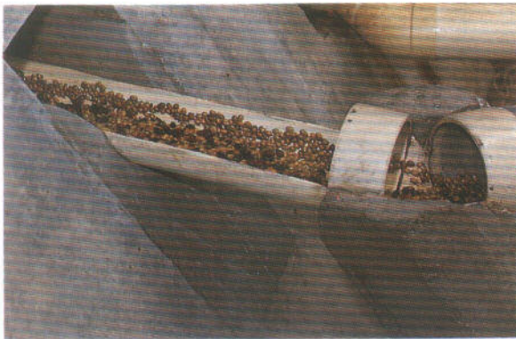
Figura 4. Utilizando la gravedad para transportar el café en baba.
