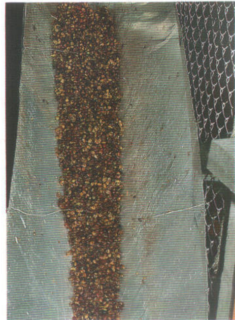
Figura 5. Utilizando la gravedad para transportar la pulpa a las fosas.
