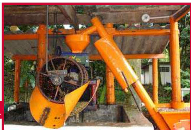
Figura 5. a) Vista general del separador hidráulico (SHTS-600), diseñado y construido en Cenicafé por Oliveros et al. (2004); b) Material separado.
