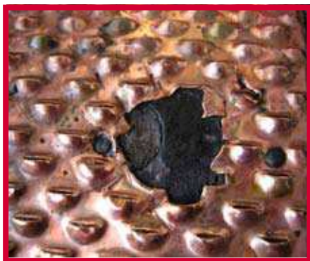
Figura 1. Daños en la camisa de una despulpadora ocasionados por objetos duros.
