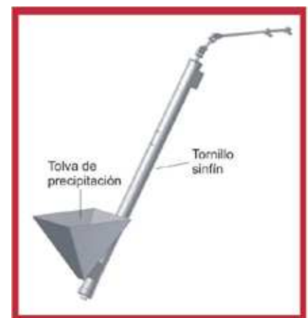
Figura 2. Dibujo del Separador Hidráulico de Tornillo Sinfín SHTS.
