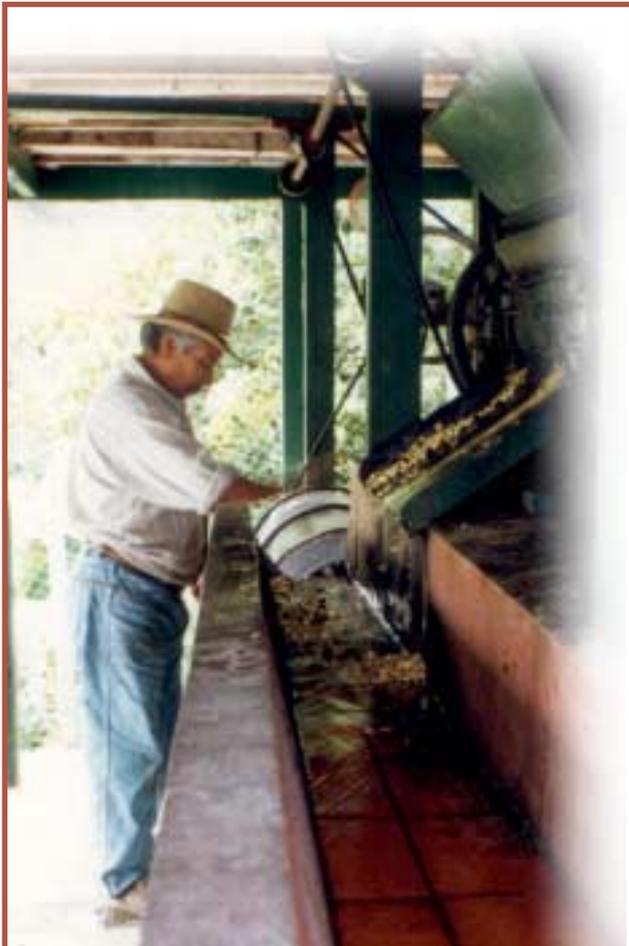
*Beneficio tradicional del café. Despulpado y transporte del café hacia los tanques de fermentación*
