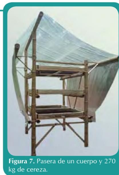
**Figura 7.** Pasera de un cuerpo y 270 kg de cereza.
