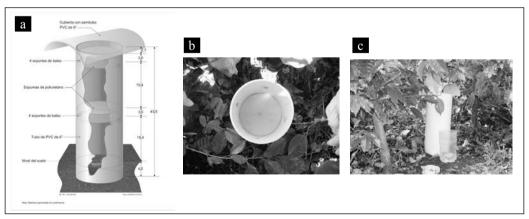
Figura 1. a) Esquema del colector de amoníaco; b) Colector de amoníaco con la espuma inferior; c) Colector de amoníaco instalado en el campo.
