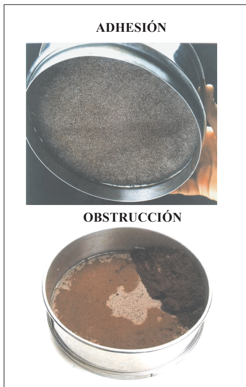
Figura 4. Fenómenos de adhesión y obstrucción ocurridos durante el proceso de tamizado, especialmente, de café fino.
