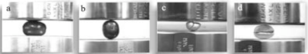
Figura 1. Condiciones de carga para el café en cereza y en pergamino lavado y seco: ecuatorial (a y c) y polar (b y d).
