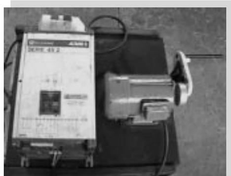
Figura 2. Sistema sincronizador de frecuencias y fuente de potencia.
