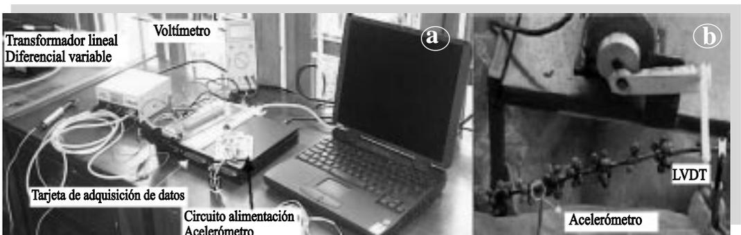
Figura 3. Montaje de laboratorio. (a) Equipos utilizados para la adquisición de datos. (b) Ubicación de sensores en la rama
