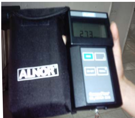
Medidor de CO 2
