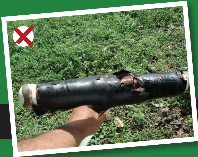
Figura 3. Desgaste del protector del selector de arvenses debido a que es arrastrado por el suelo.
