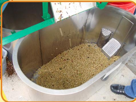
Deposite el café despulpado en el recipiente o tanque para realizar la fermentación.
